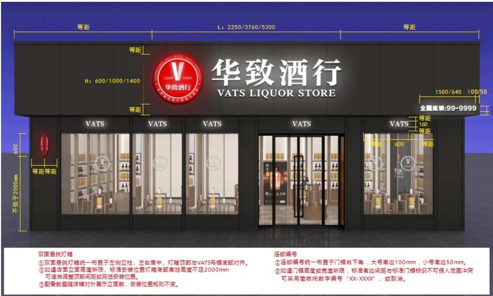
4-1 外立面标识安装施工规范 - 安装定位
